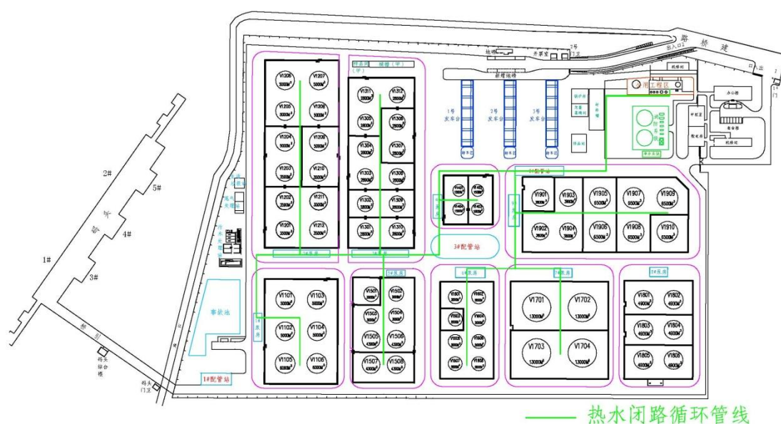
图 3.2-1 厂区热水闭路循环系统图
