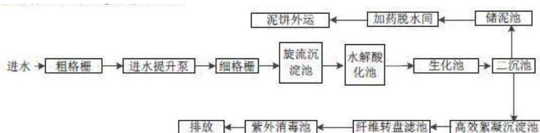
图 5.1-2 江苏港城污水处理有限公司处理工艺流程图
